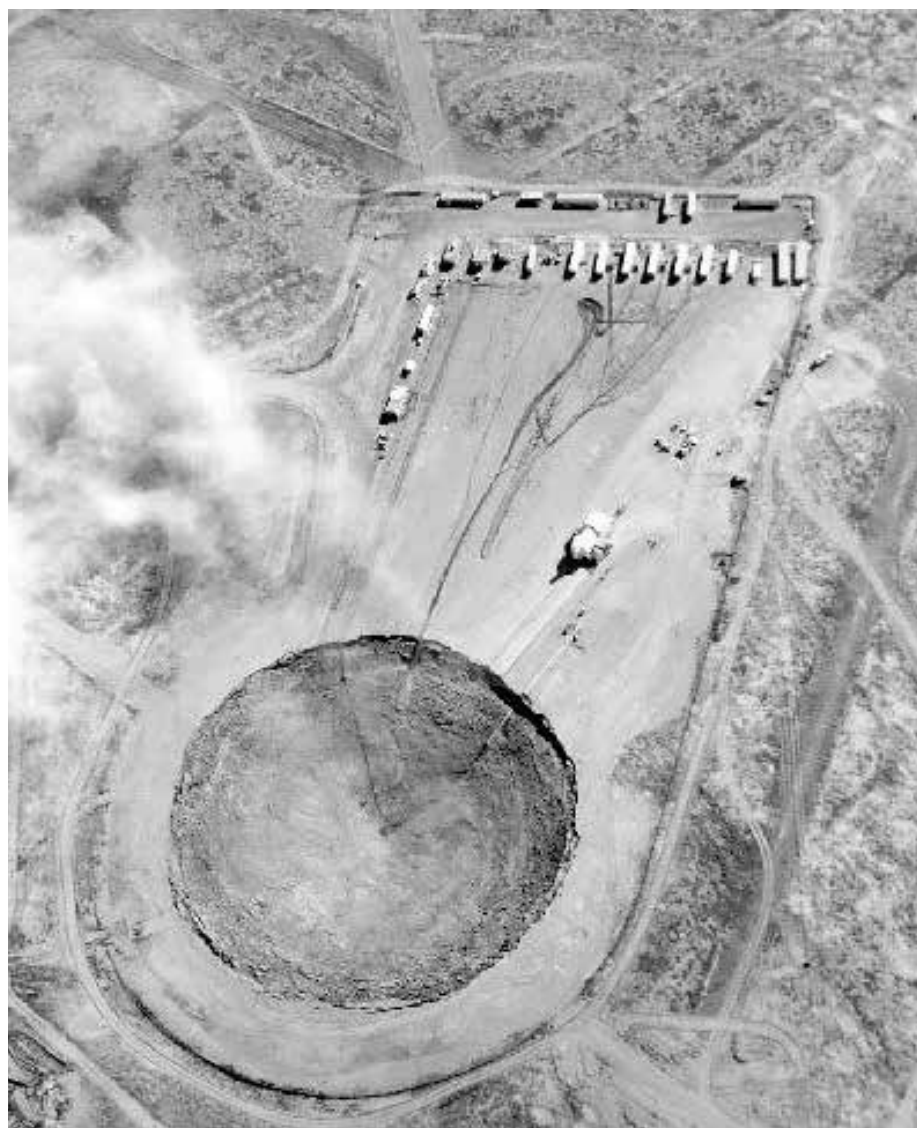
Abb. 3: Typischer Krater einer Nukleardetonation im sandigen Untergrund. Sichtbar sind auch die in unmittelbarer Nähe aufgestellten Messeinrichtungen (Bild: USDOE, public domain)
