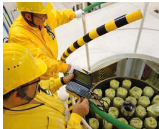
Abb. 4: IAEA-Safeguardsinspektoren überprüfen den Anreicherungsgrad von neuen Brennstäben (Bild: IAEA)
